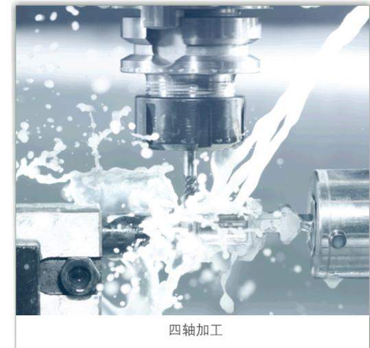
优异的C轴和Z轴同步控制功能，提高刚性攻丝的速度和精度。在适配永磁同步主轴电机情况可实现M3丝锥4000转/分钟刚性攻丝。
